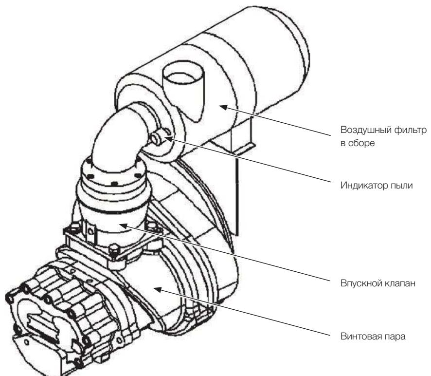
Рис. 4.3 Система воздухозабора
